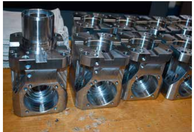
6 Reduzierte Stückkosten, höhere Bauteilqualität und schnellere Auftragsdurchlaufzeiten bei komplexen Fertigungsaufgaben: auf der Nakamura bei Heimatec gefertigte Gehäuse für angetriebene Werkzeuge (© Hommel)
