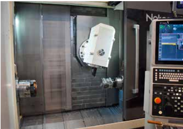
5 Durch die stabile Bauweise und einen Abstand von 1350 mm zwischen den Spindelnasen eignet sich das Drehfräszentrum NTRX-300 perfekt für die Komplettbearbeitung komplexer Werkstücke bis zu einem Drehdurchmesser von 640 mm bei Drehlängen bis 1150 mm (© Hommel)
