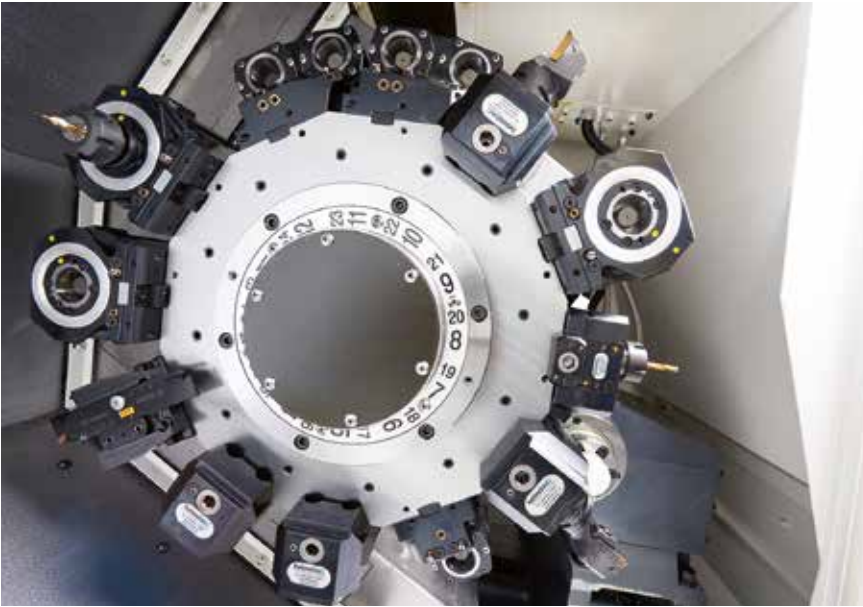
3 Das modulare Schnellwechselsystem heimtec.Capto umfasst außer einer breiten Palette an Standardwerkzeugen mit Capto-Aufnahmen viele maschinenoptimierte Aufnahmen (© Heimtec)
