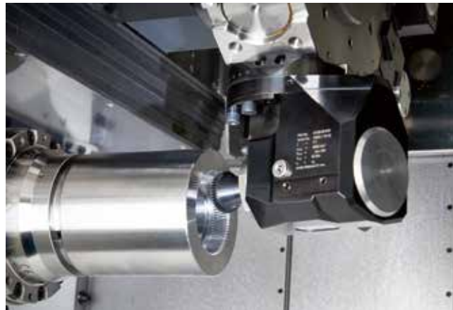
3 Das modulare Schnellwechselsystem heimtec.Capto umfasst außer einer breiten Palette an Standardwerkzeugen mit Capto-Aufnahmen viele maschinenoptimierte Aufnahmen (© Heimtec)
