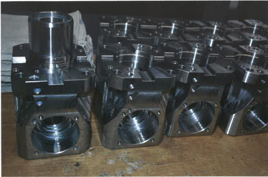
Bild 6: Auf der Nakamura gefertigte Gehäuse für angetriebene Werkzeuge
