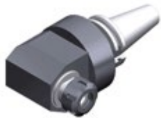
tête de perçage et de fraisage angu- laire, pivotante à 360° 7 030 .../7 039 ...
